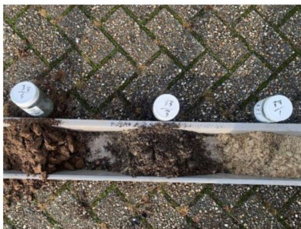
Foto 66. Profiel ondergrond boring 33
