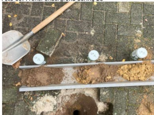
Foto 62. Profiel ondergrond boring 27
