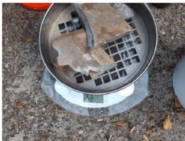
Foto 74. Asbestverdacht materiaal proefgat 67
