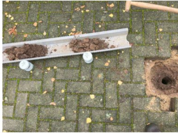
Foto 58. Profiel ondergrond boring 23
