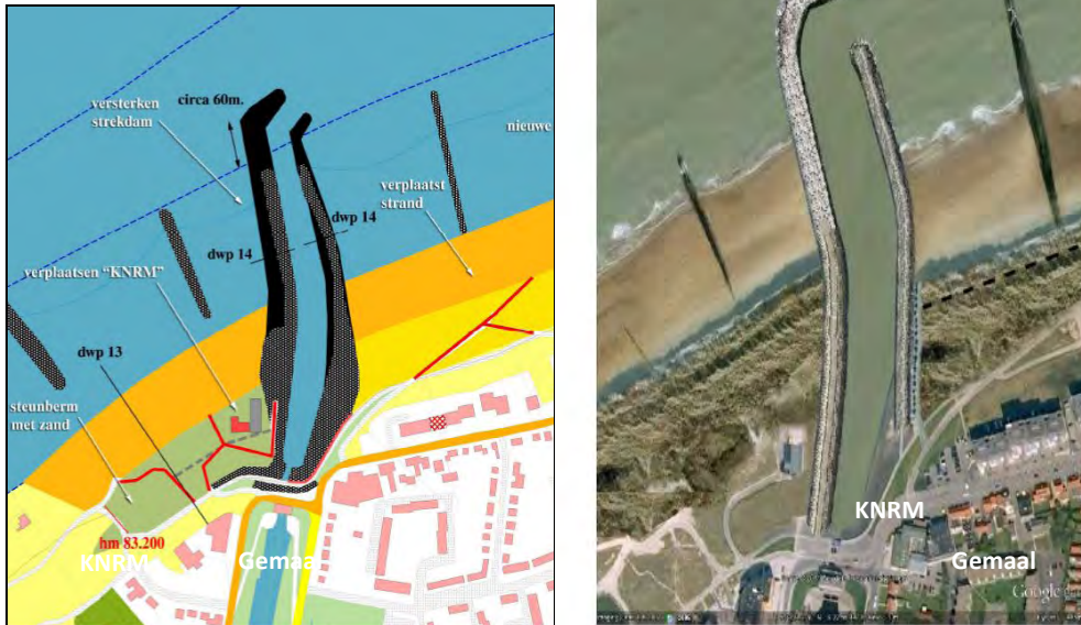
Figuur 2.4 Principeontwerp KVP (links) en alternatief 'HWBP' (rechts)
