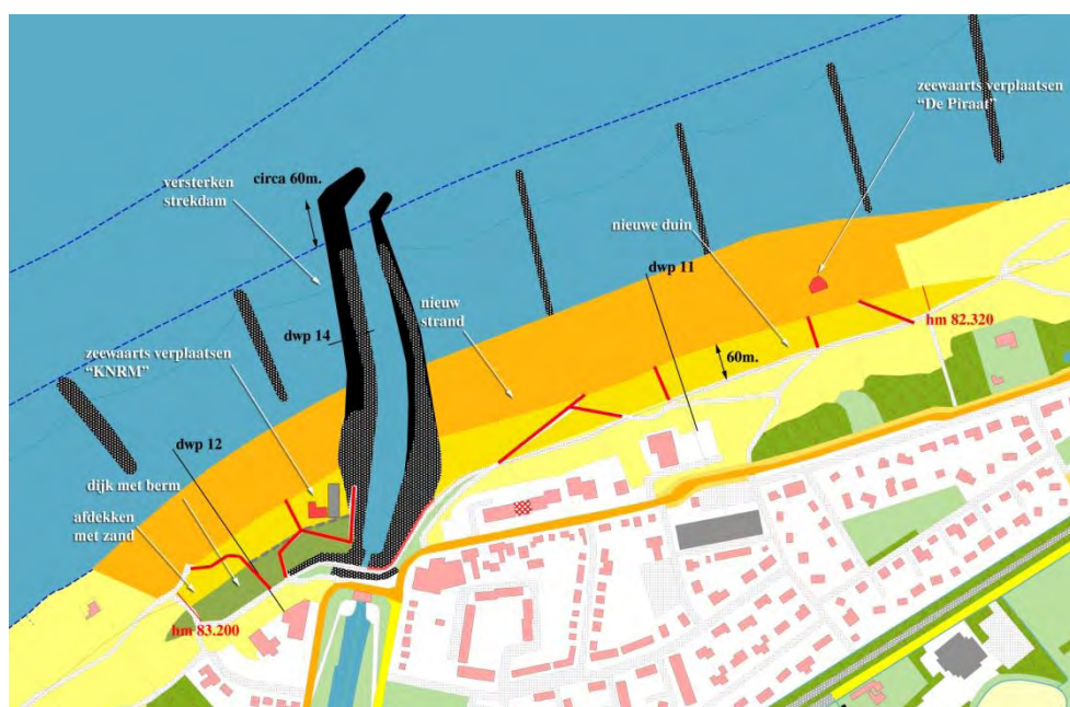
Figuur 1.2: Principe ontwerp Cadzand-Bad uit Kustversterkingsplan, DHV et al (2007).
