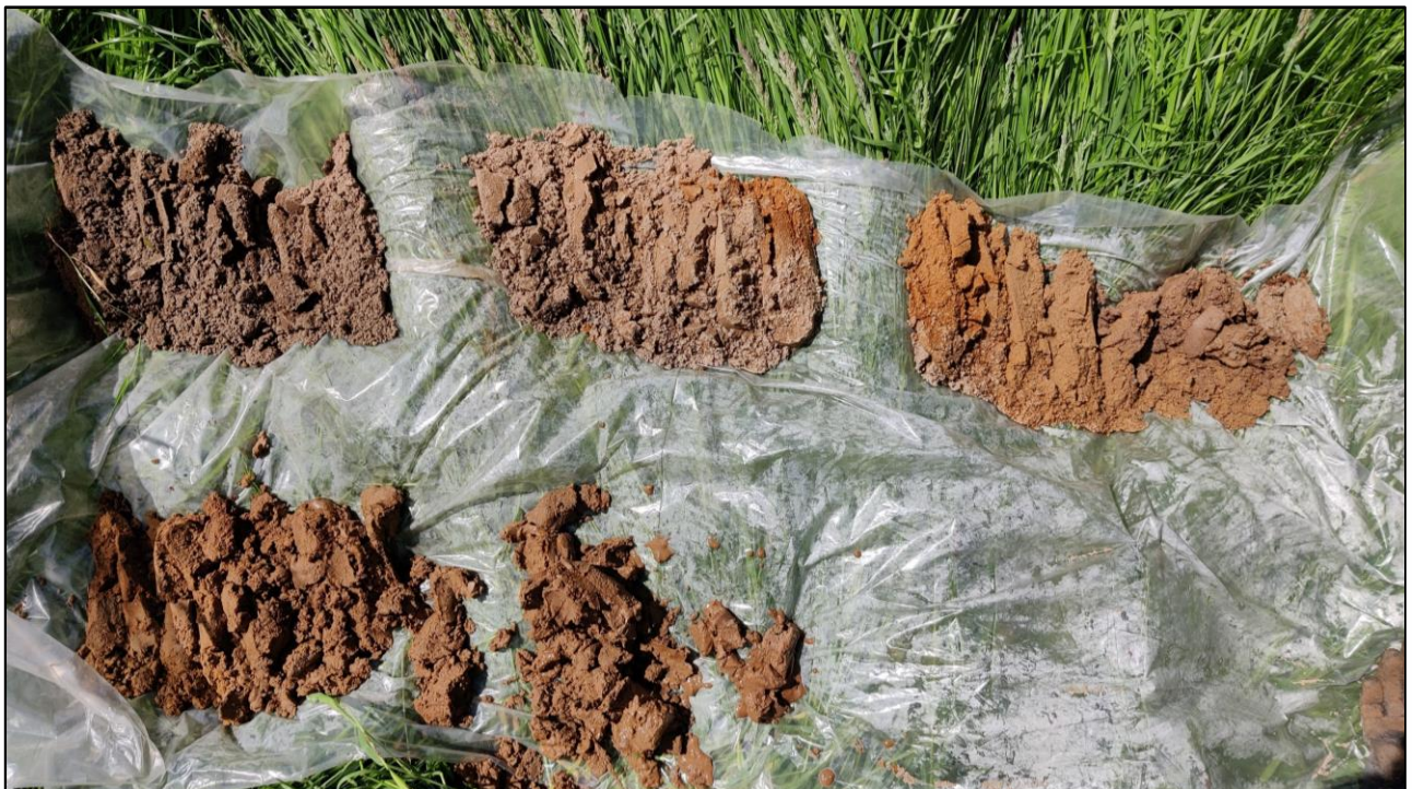
Afbeelding: Profielboring 9 vanaf maaiveld (linksboven) tot 2,4 meter onder maaiveld (rechtsonder).
